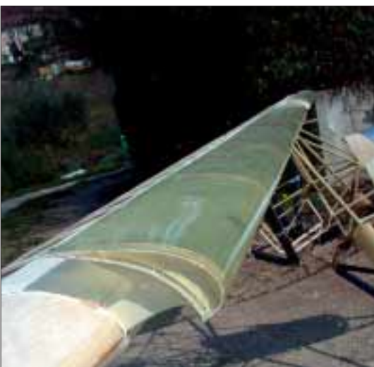
Vorflügel haben es in sich, aber dank der einfachen Negativform aus Abb. 2 besitzen auch die Nachbauten die charakteristischen Dellen
