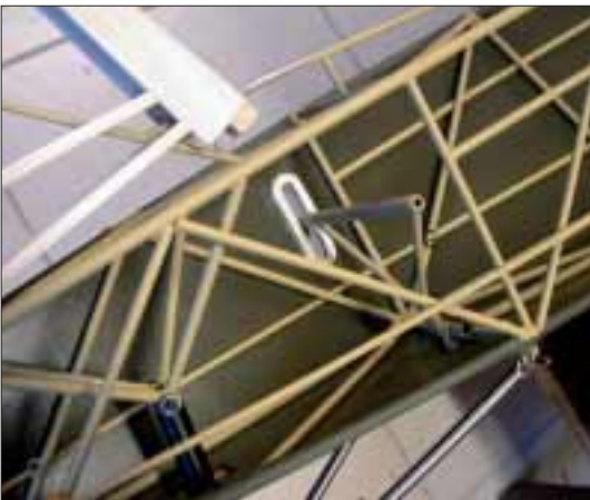
Blick auf die HLW-Aufnahme: Zwecks Trimmung kann die EWD über diese Mechanik verstellt werden
