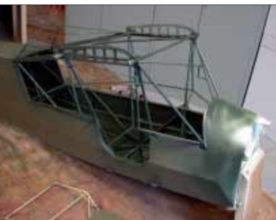
Dank der großzügigen Cockpitverglasung bleibt ein wesentlicher Teil der Gitterrumpfstruktur sichtbar
