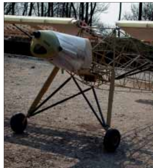
Während Großteile der Motorhaube aus gebogenem Offsetblech bestehen, wurde das Frontteil laminiert
