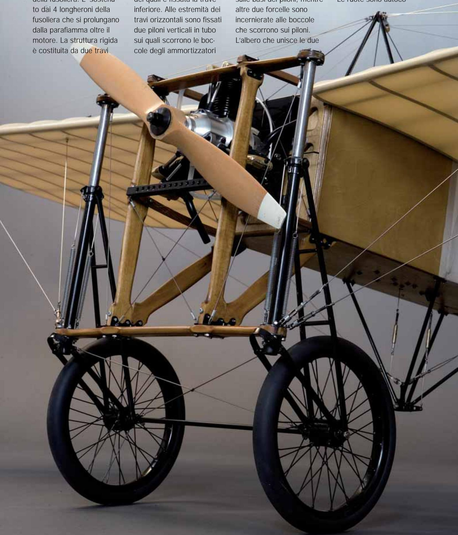
struite, o meglio, sono ricavate da due ruote da carrozzina che mi ha regalato Gabriele Ottaviani, grande specialista in ruote a raggi. Le ruote da carrozzina avevano 12 raggi in tondino da 3 mm, io ho sostituito progressivamente i 12 raggi da 3 mm con 36 raggi da 1 mm fissandoli con saldatura autogena. In questo modo il mozzo è sempre rimasto centrato nel cerchione della ruota (vedi le foto sotto). Questo lavoro è stato alquanto tedioso e ha richiesto un intero fine settimana.
