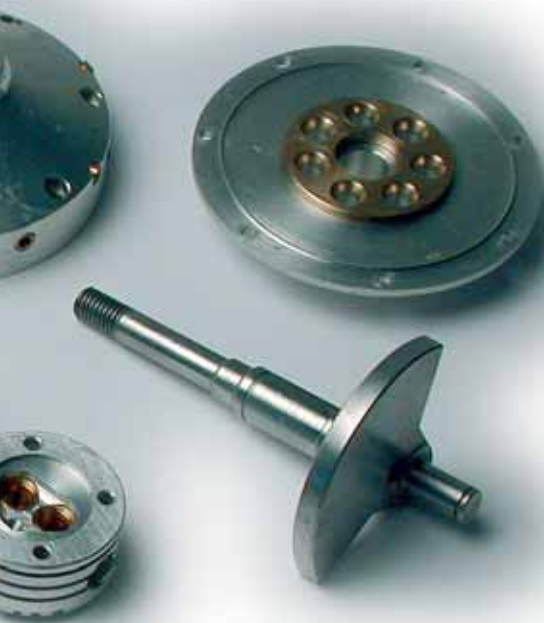
In questa foto il motore di Luciano Granella. A fianco, alcuni dei componenti del motore. La corona a camme della distribuzione è il pezzo più impegnativo da costruire. Nella foto piccola, il motore durante il rodaggio. (Il progetto è dell'Ing. Standar e penso sia ancora in catalogo presso la rivista francese MRA.)
