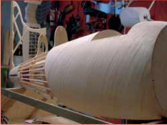
*Die diagonale Streifenbeplankung liegt im Winkel von +/- 45 Grad. Das gibt eine äußerst stabile und vor allem runde Außenhaut*
