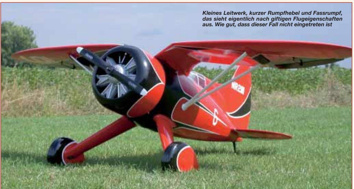
*Kleines Leitwerk, kurzer Rumpfhebel und Fassrumpf, das sieht eigentlich nach giftigen Flugeigenschaften aus. Wie gut, dass dieser Fall nicht eingetreten ist*
