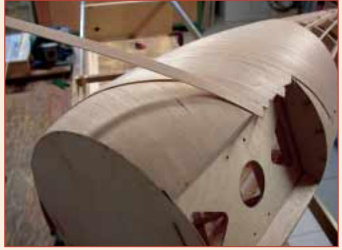
*Nach dem Aufbringen der ersten Lage sieht die Außenhaut dann so aus. Nach einem Zwischenschliff wird die zweite Lage um 90 Grad versetzt aufgebracht*
