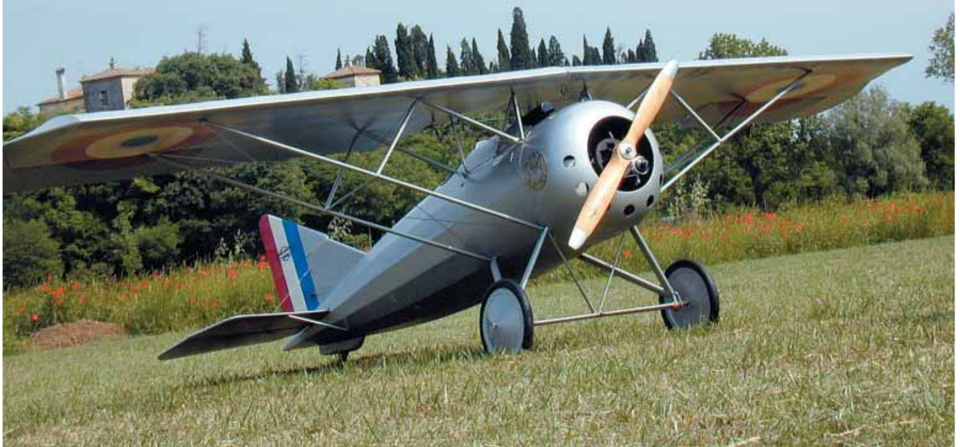
Dieses Foto zeigt alle ungewöhnlichen Stilelemente der »Morane« auf einen Blick: das Fahrwerk mit seinen hohen »Stelzen«, die Parasol-Tragfläche mit ihrer Rückpfeilung und den zigarrenförmigen Rumpf
